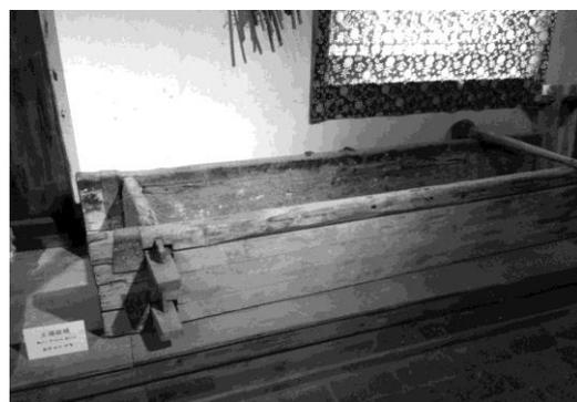
图 50：打土墙模板
